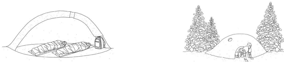
Bild 187. Det är viktigt att quinzeen har ett ventilationshål och att den hålls öppen hela tiden, även vid snöfall. (efter Bauer 2007)
